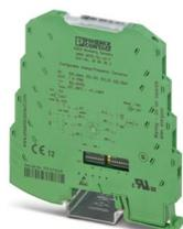
Convertidor de frecuencia analógico para convertir señales analógicas normalizadas en señales de frecuencia o señales de modulación de duración de impulsos (PWM), configurable a través de interruptor DIP, con conexión por tornillo
