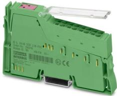
Inline, Módulo de relés, Salidas por relé: 2 (libre de potencial), Conmutador, 24 V AC, 48 V DC, para conectar cargas óhmicas, velocidad de transmisión en el bus local: 500 kBit/s, índice de protección: IP20, incluidos Inline conector y superficie de rotulación
