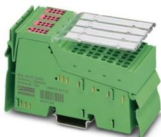
Inline, Módulo de salida digital, Salidas digitales: 32, 24 V DC, 500 mA, tecnología de conexión: 1 conductor, velocidad de transmisión en el bus local: 500 kBit/s, índice de protección: IP20, incluidos conectores Inline y campos de rotulación
