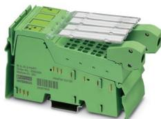
Inline, Módulo de entrada analógica, Entradas analógicas: 2, 4 mA ... 20 mA, 0 mA ... 25 mA, tecnología de conexión: 2 conductores, velocidad de transmisión en el bus local: 500 kBit/s, HART - Funcionalidad, Transmisión de protocolo HART, índice de protección: IP20, incluidos conectores Inline y campos de rotulación
