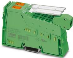
Inline, Módulo de comunicación, interfaz RS-485, RS-422: 1 (con funcionamiento alternativo), Comunicación mediante PCP, velocidad de transmisión en el bus local: 500 kBit/s, índice de protección: IP20, incluidos conectores Inline y campos de rotulación
