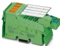
Borne de posicionamiento Inline, completo con accesorios (conector y superficie de rotulación), 1 entrada transmisor de valor incremental, 4 entradas digitales 24 V DC, 4 salidas digitales 24 V DC, 500 mA, técnica de conexión de 3 conductores
