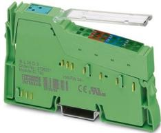
Inline, Módulo de entrada digital, Entradas digitales: 2, 24 V DC, tecnología de conexión: 4 conductores, velocidad de transmisión en el bus local: 2 MBit/s, índice de protección: IP20, incluidos Inline conector y superficie de rotulación
