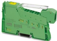
Inline, Borne de salida analógica, Salidas analógicas: 2, 0 V ... 10 V, -10 V ... 10 V, tecnología de conexión: 2 conductores, velocidad de transmisión en el bus local: 500 kBit/s, índice de protección: IP20, incluidos Inline conector y superficie de rotulación
