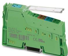
Inline, Módulo de entrada digital, Entradas digitales: 2, 24 V DC, tecnología de conexión: 4 conductores, velocidad de transmisión en el bus local: 500 kBit/s, índice de protección: IP20, incluidos Inline conector y superficie de rotulación
