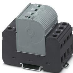
Descargador tipo 2 enchufable (descargador de sobretensiones) a prueba de corriente de fuga, para redes trifásicas de alimentación de corriente, con N y PE separados (sistema de 5 conductores: L1, L2, L3, N, PE), con contacto de telecomunicaciones.
