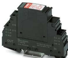
Descargador enchufable tipo 3 (protecc. aparatos) para redes monofásicas de alimentación con N y PE separados (sistema de 3 cond.: L1, N, PE), con contacto indic. remota.
