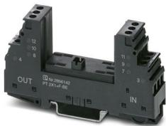
Elemento de base para protección enchufable PT con circuito de protección para dos conductores de circuitos de señales con tierra unilateral. Descargador de gas integrado como protección basta entre GND y PE. Montaje en NS 35/7,5 y NS 35/15, anchura de la carcasa: 17,5 mm.
