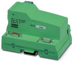
Acoplador de bus INTERBUS, conexión D-SUB, velocidad de transmisión de 2 Mbaudios, 24 V DC, sin accesorios
