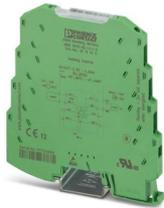
Acondicionador de señal de 3 vías, para la separación galvánica de señales analógicas, con conexión por tornillo, señal de entrada: 0 V ... 10 V, señal de salida: 4 mA ... 20 mA
