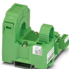
Convertidor de corriente MCR, para medir corrientes alternas sinusoidales y no sinusoidales, corriente de entrada 0...400 A, tensión de salida 0...(5) 10 V
