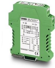
Convertidor de temperatura MCR, para termopares tipo J, K, entrada: 0-400 °C, 0-800 °C, 0-1000 °C, 0-1200 °C, entrada separada galvánicamente, señal de salida 0(4)...20 mA
