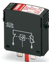
Protección enchufable contra sobretensiones tipo 2 con varistor de alta potencia para elemento de base VAL-MS, con control térmico, indicación óptica de defecto. Ejecución: 500 V AC
