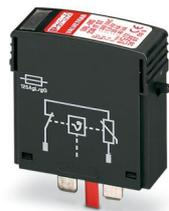
Protección enchufable contra sobretensiones tipo 2 con varistor de alta potencia para elemento de base VAL-MS, con control térmico, indicación óptica de defecto. Ejecución: 230 V AC (sistema IT)
