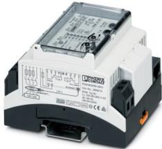
Monitor de corriente diferencial en ejecución tipo B+ para el reconocimiento de corrientes de defecto alternas y continuas tanto lisas como pulsatorias hasta 100 kHz.
