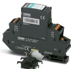
Protección contra sobretensiones que consta de protección enchufable y elemento de base, con indicación de estado de varios niveles integrada en módulo para un circuito de señales de 2 hilos libre de potencial a tierra. Puede utilizarse en circuitos orientados a la seguridad hasta SIL 3.
