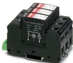
Dispositivo de protección contra sobretensiones / corrientes de rayo para sistemas fotovoltaicos de tensión continua aislados y puestos a tierra de 1000 V DC y 2 polos, para montaje sobre carril DIN, elemento de base de 3 polos con contacto de indicación remota, tres elementos de protección enchufables con monitorización de temperatura, mensaje de estado en cada conector.
