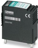
Protección enchufable contra sobretensiones con indicación de diagnóstico y estado de varios niveles integrada en el módulo para cinco conductores de señal. Para aplicaciones de alta frecuencia. Tensión nominal: 12 V DC
