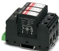
Dispositivo de protección contra sobretensiones para sistemas fotovoltaicos de tensión continua aislados y puestos a tierra de 1000 V DC y 2 polos, para montaje sobre carril DIN, elemento de base de 3 polos con contacto de indicación remota, tres elementos de protección enchufables con monitorización de temperatura, mensaje de estado en cada conector.
