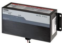
Módulo de protección contra sobretensiones para configuraciones de fases auxiliares/ fases individuales 120/240 V AC. Utiliza una carcasa compacta NEMA, que puede conectarse fácilmente con una carcasa existente. El Sine Wave Tracking híbrido ofrece una protección contra sobretensiones de 50 kA.
