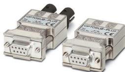
Adaptador de fibra óptica INTERBUS, para la conversión de la interfaz Remote-IN a fibra de vidrio, técnica de conexión: B-FOC
