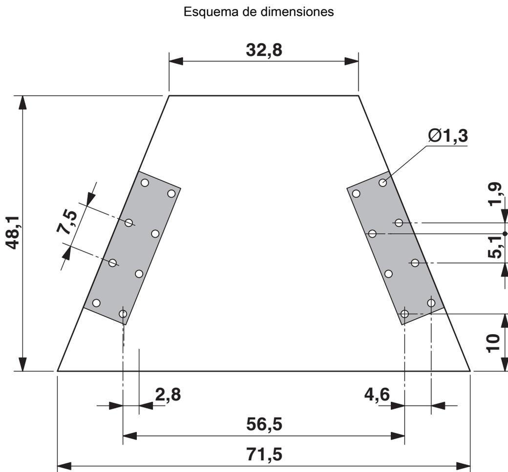
Cara de soldaduras del diseño de placas de circuito impreso
