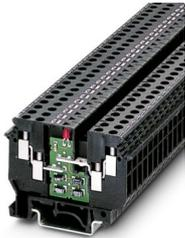
Borne para componentes, tensión nominal: 500 V, corriente nominal: 0,5 A, 1er piso, tipo de conexión: Conexión por tornillo, Sección de dimensionamiento: 4 mm<sup>2</sup>, sección: 0,2 mm<sup>2</sup> - 6 mm<sup>2</sup>, montaje: NS 35/7,5, NS 35/15, NS 32, color: negro
