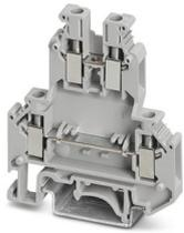
Borna de doble piso, tensión nominal: 500 V, corriente nominal: 32 A, tipo de conexión: Conexión por tornillo, 1er y 2º piso, Sección de dimensionamiento: 4 mm<sup>2</sup>, sección: 0,2 mm<sup>2</sup> - 4 mm<sup>2</sup>, clase de montaje: NS 35/7,5, NS 35/15, color: gris
