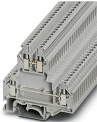
Borna de doble piso, tensión nominal: 500 V, corriente nominal: 24 A, tipo de conexión: Conexión por tornillo, 1er y 2º piso, Sección de dimensionamiento: 2,5 mm<sup>2</sup>, sección: 0,2 mm<sup>2</sup> - 4 mm<sup>2</sup>, clase de montaje: NS 35/7,5, NS 35/15, NS 32, color: gris
