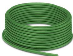
Por metros, Cable de bus remoto de instalación, INTERBUS, apantallado, PUR, verde mayo RAL 6017, 9-conductores ( $3 \times 2 \times 0,25 \text{ mm}^2 + 3 \times 1 \text{ mm}^2$ ), color conductores individuales: verde-amarillo, blanco-marrón, gris-rosa, rojo, azul, verde/amarillo, muy flexible, resistente a salpicaduras de soldadura
