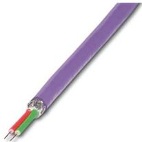
Por metros, Cable de sistema de bus, PROFIBUS (12 MBit/s), apantallado, PVC FR VI/PVC, violeta, 2-conductores (1x2xAWG22/1), color conductores individuales: rojo, verde, longitud de cable: Libre entrada (1,0 ... 1000,0 m)
