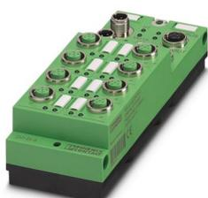
El equipo Stand-Alone para CANopen® tiene 16 entradas digitales. La conexión M12 se efectúa a través de la técnica de conexión rápida. La alimentación de 24 V CC está protegida contra cortocircuitos y sobrecarga. La corriente nominal del aparato es de 1,2 A.
