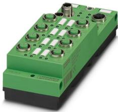
El equipo Stand-Alone para PROFIBUS tiene 8 entradas digitales. La conexión M12 se efectúa a través de la técnica de conexión rápida. La alimentación de 24 V CC está protegida contra cortocircuitos y sobrecarga. La corriente nominal del aparato es de 600 mA.
