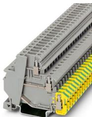
Borna de actuador/sensor de proximidad, tensión nominal: 250 V, corriente nominal: 24 A, tipo de conexión: Conexión por tornillo, Sección de dimensionamiento: 2,5 mm<sup>2</sup>, sección: 0,2 mm<sup>2</sup> - 4 mm<sup>2</sup>, clase de montaje: NS 35/7,5, NS 35/15, color: gris
