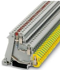
Borna de actuador/sensor de proximidad, tensión nominal: 24 V, corriente nominal: 24 A, tipo de conexión: Conexión por tornillo, Sección de dimensionamiento: 2,5 mm<sup>2</sup>, sección: 0,2 mm<sup>2</sup> - 4 mm<sup>2</sup>, clase de montaje: NS 35/7,5, NS 35/15, color: gris
