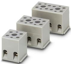
Terminal de aparato, tensión nominal: 500 V, corriente nominal: 32 A, número de conexiones: 12, número de polos: 6, tipo de conexión: Conexión por tornillo, Sección de dimensionamiento: 4 mm<sup>2</sup>, sección: 0,2 mm<sup>2</sup> - 4 mm<sup>2</sup>, clase de montaje: atornillado directo, color: gris
