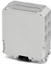
Caja para carril DIN, Carcasa completa con pasador de metal, diseño alto, sin rendijas de ventilación, anchura: 45,2 mm, altura: 99 mm, profundidad: 113,65 mm, color: gris claro (similar RAL 7035), puentado transversal: Conector de bus para carril DIN (opcional), número de polos conector transversal: 5
