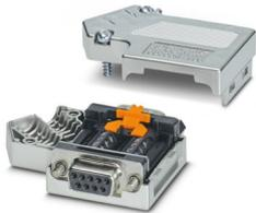
Conector D-SUB hembra de 9 polos, salida de cables a 35°, sistema de bus: CAN, CANopen®, SafetyBus-P hasta 1 Mbit, con conector hembra D-SUB PG para la conexión de un equipo de programación, resistencia de cierre conectable mediante conmutador deslizante, asignación de pines: 2, 3, 7, 9; bornas de tornillo
