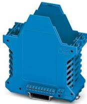
Caja para carril DIN, Parte inferior de la carcasa con pasador de metal, con 2 contactos FE, diseño alto, con rendijas de ventilación, anchura: 45,2 mm, altura: 99 mm, profundidad: 107,3 mm, color: azul (similar RAL 5015), puentado transversal: conector bus integrado, número de polos conector transversal: 10+2, Conector de bus: 10 contactos en paralelo, 2 contactos en serie
