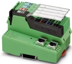
Inline, Acoplador de bus, Modbus/TCP (UDP), Hembra RJ45, Entradas digitales: 8, 24 V DC, tecnología de conexión: 3 conductores, Salidas digitales: 4, 24 V DC, 500 mA, tecnología de conexión: 3 conductores, velocidad de transmisión en el bus local: 500 kBit/s / 2 MBit/s, índice de protección: IP20, incluidos conectores Inline y campos de rotulación
