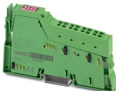
Inline, Módulo de salida digital, Salidas digitales: 8, 24 V DC, tecnología de conexión: 1 conductor, velocidad de transmisión en el bus local: 500 kBit/s, índice de protección: IP20, Conector Inline incluido
