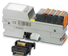
Axioline F, Módulo de salida analógica, Salidas analógicas: 4, 0 V ... 5 V, -5 V ... 5 V, 0 V ... 10 V, -10 V ... 10 V, 0 mA ... 20 mA, 4 mA ... 20 mA, tecnología de conexión: 2 conductores, velocidad de transmisión en el bus local: 100 MBit/s, Variante Extreme Conditions, índice de protección: IP20, incluido módulo de zócalo de bus y conectores Axioline F
