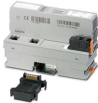
Axioline F, Acoplador de bus, Modbus/TCP (UDP), Hembra RJ45, Variante Extreme Conditions, velocidad de transmisión en el bus local: 100 MBit/s, índice de protección: IP20, incluidos módulo base de bus y conector Axioline F
