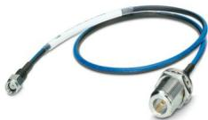
Cable de antena para el pasamuros de armario de control, diámetro exterior: 3,2 mm, conductor interior: flexible, amortiguación: 0,6/0,9/1,4 dB con 0,9/2,4/5,8 GHz, conexión: N (hembra) -> RSMA (macho), longitud de cable: 0,5 m
