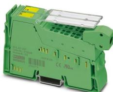
Inline, Borne de salida analógica, Salida analógica: 1, 0 V ... 10 V, 0 mA ... 20 mA, 4 mA ... 20 mA, tecnología de conexión: 2 conductores, velocidad de transmisión en el bus local: 500 kBit/s, Variante Extreme Conditions, índice de protección: IP20, incluidos conectores Inline y campos de rotulación
