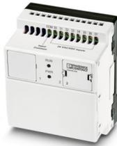
Unidad base Nanoline de 24 V DC. Equipada con 6 entradas digitales y 4 canales de salida de relé digitales. Pueden agregarse canales de E/S y como máximo pueden utilizarse 3 módulos de ampliación de E/S. Unos módulos de comunicación opcionales facilitan la conectividad en red o conectividad serie. Aparato de operación opcional con interfaz de usuario. Programación mediante nanoNavigator.
