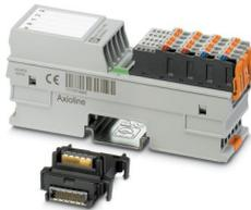
Axioline F, Módulo de registro de temperatura, Entradas analógicas: 4 (para sensores de temperatura resistivos), tecnología de conexión: 2, 3, 4 conductores (apantallados), velocidad de transmisión en el bus local: 100 MBit/s, índice de protección: IP20, incluido módulo de zócalo de bus y conectores Axioline F
