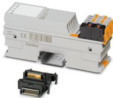
Módulo de función especial Axioline F, 1 interfaz SSI para transmisor de valor absoluto, 1 salida analógica: 0-10 V,  $\pm 10$  V, 0-5 V,  $\pm 5$  V, 0-20 mA, 4-20 mA,  $\pm 20$  mA, técnica de conexión de 2 conductores (incluida base de bus y conectores machos)
