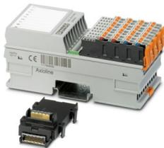
Axioline F, Módulo de registro de temperatura, Entradas analógicas: 8 (8 entradas para elem. térmicos o tensión lineal, adic. 1 entrada -5 V hasta +5 V), tecnología de conexión: 2 conductores (apantallados, trenzados por pares), velocidad de transmisión en el bus local: 100 MBit/s, índice de protección: IP20, incluido módulo de zócalo de bus y conectores Axioline F
