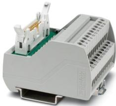
Módulo VARIOFACE, con conexión por tornillo y conector enchufable de cable plano, para el montaje sobre carriles simétricos NS 35, con conector macho, así como bridas de bloqueo cortas y largas para conectores hembra, número de polos: 20, con LED
